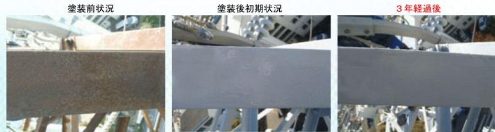
鉄塔部材を切断、塗装後 サイクル腐食試験 (JIS K 5600-T-9 サイクルA)
